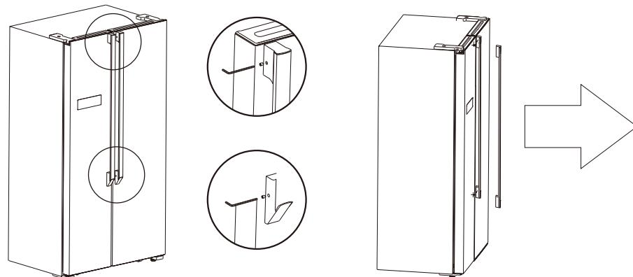
Als de deuren in uw huis niet breed genoeg zijn om de koelkast te verplaatsen, kunt u de twee deurgrepen verwijderen: draai de handgrepen los met een inbusleutel en trek de handgrepen naar buiten. Ga in omgekeerde volgorde te werk om beide handgrepen weer aan de koelkast te bevestigen.
