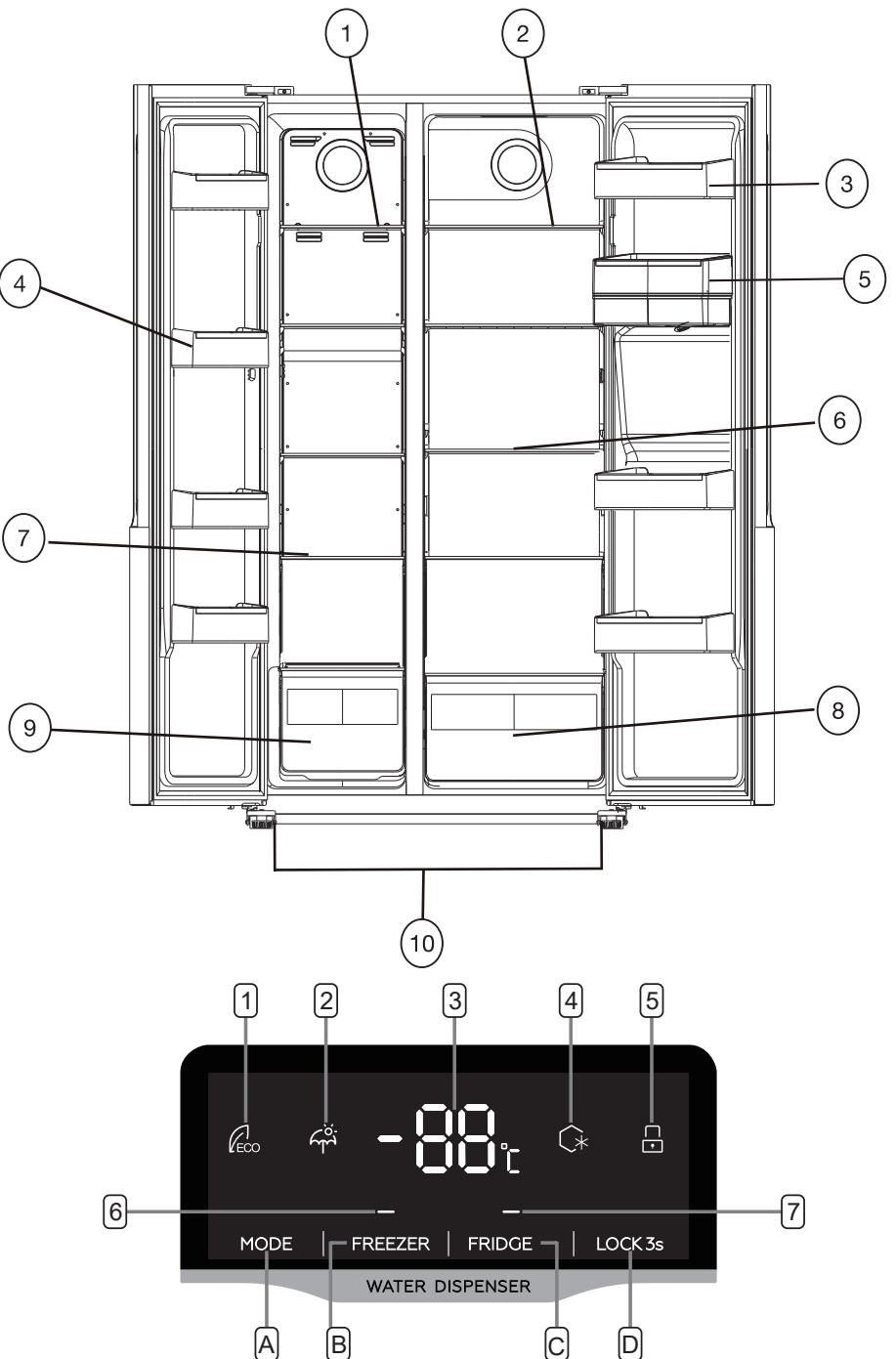
Die in der Gerätebeschreibung dargestellte Anordnung der Schubladen, Fächer und Ablagen wurde so gewählt, dass die Energie möglichst effizient genutzt wird.
