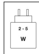
Het vermogen dat door de lader wordt geleverd, moet minimaal 2 Watt zijn voor de radioapparatuur en maximaal 5 Watt zijn om de maximale laadsnelheid te bereiken.
