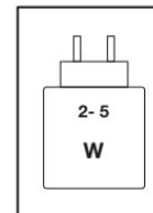
La puissance fournie par le chargeur doit être entre, au minimum, 2 Watts requis par l'équipement radioélectrique et, au maximum, 5 Watts pour atteindre la vitesse de chargement maximale.
