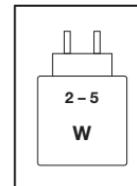
Das Ladegerät muss eine Leistung von mindestens 2 Watt, wie vom Funkgerät gefordert, und höchstens 5 Watt liefern, um die maximale Ladegeschwindigkeit zu erreichen.
