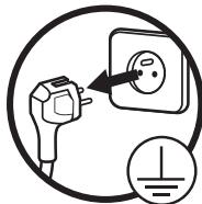
**Débranchez l'appareil de la prise électrique lors de l'inversion du sens d'ouverture de la porte.**
