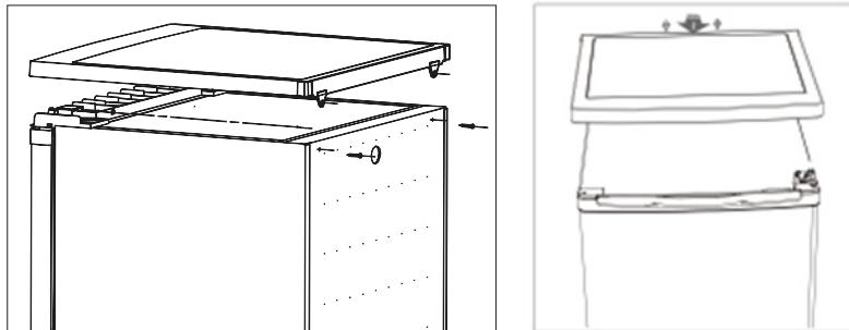
3. Retirez les **deux vis** du **support de la charnière supérieure de droite** et desserrez les **deux vis de gauche**. Soulevez ensuite le support de la charnière pour le retirer.
