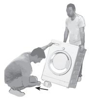
Inclinez le lave-linge vers l'arrière pour retirer le renfort de conditionnement. Retirez le renfort de conditionnement en tirant sur le ruban. Ne réalisez pas cette opération seul.
