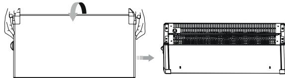
4. Platzieren und befestigen Sie jeden Fuß mit den mitgelieferten Schrauben auf jeder Seite des Geräts.
