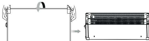
4. Plaats en bevestig beide poten met de meegeleverde schroeven aan weerszijden van het apparaat.
