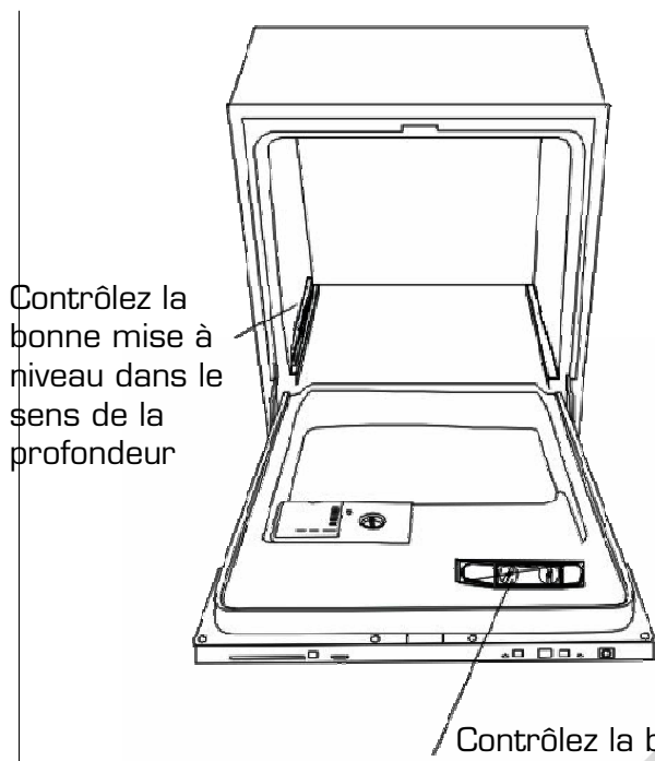
[Figure 7] Mise à niveau
