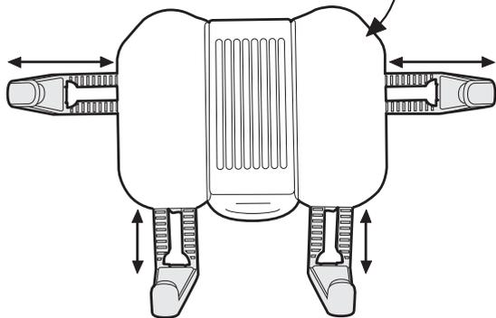
③ Dévissez les boulons pour fixer le bras de maintien sur l'appui-tête.
