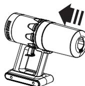
B. Tenez l'appareil et appuyez sur le bouton bac de démontage. Alignez le point de référence du bac à poussières avec celui de l'appareil.
