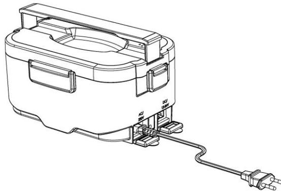
**Tension DC 12-24 V pour l'alimentation nomade, insérez l'adaptateur dans une prise allume cigare. La lumière s'allume et commence à fonctionner**
