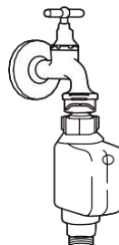
tuyau d'arrivée d'eau de sécurité
