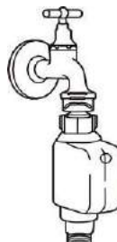
manguera de entrada agua de seguridad
