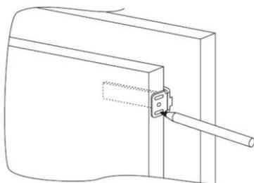
4. Connectez la porte de l'appareil au panneau de l'armoire en gardant les fentes de chargement comme lignes directrices.
