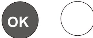
Si "OK" n'apparaît pas, cela signifie que la température est trop élevée. Réglez le thermostat sur une position supérieure. Attendez au moins 12 heures avant de réajuster le thermostat. Après le chargement des denrées fraîches dans l'appareil ou après les ouvertures répétées (ou ouverture prolongée) de la porte, il est normal que l'inscription «OK» n'apparaisse pas dans l'indicateur de température.
