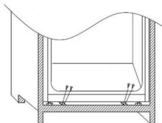
4. Posez le joint sur l'appareil, coupez la partie excessive si nécessaire. Installez les parties inférieures avec des caches en plastique.
