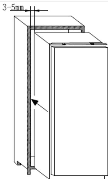
2. Lorsque vous vous êtes assuré de la concordance entre la porte de la colonne de la porte, vissez la partie supérieure de l'appareil sur l'armoire.
