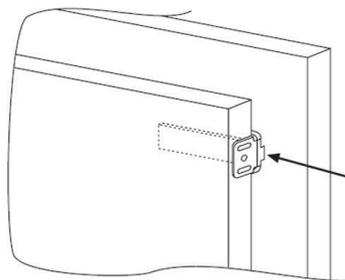
3. Marquez les points de fixation des vis et percez avec un foret d'un diamètre de 2,5 mm.
