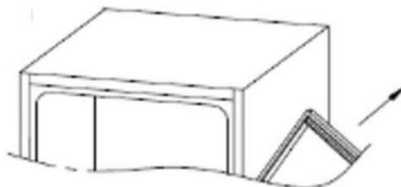
3. Retirez la charnière inférieure droite et les bouchons en plastique gauches, et réinstallez-les du côté opposé.
