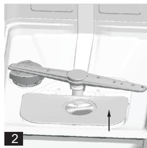
**REMARQUE :** Si vous passez de l'étape 1 à l'étape 2, le système de filtration sera retiré ; si vous passez de l'étape 2 à l'étape 1, le système de filtration sera installé **3**.
