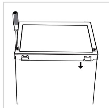
12. Mettez le capot supérieur et fixez-le avec 2 vis à l'arrière.
