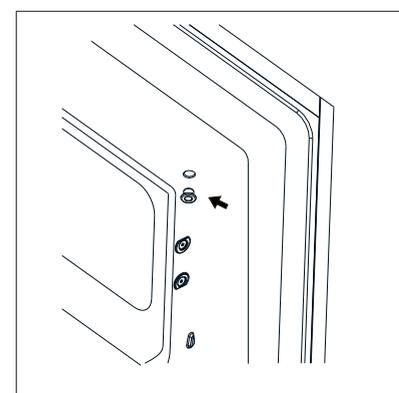
7. Faites pivoter la porte du congélateur et placez le côté charnière sur le côté gauche. Et puis fixez la porte par le support.
