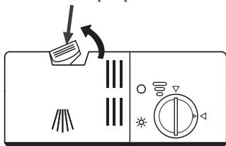
**1** Appuyez sur le loquet d'ouverture du distributeur de détergent pour ouvrir le couvercle.
