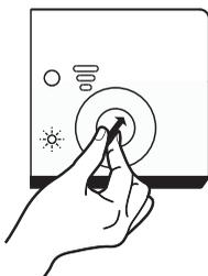
Le réservoir du liquide de rinçage possède six degrés. Le réglage d'usine recommandé est « 4 ». Si la vaisselle est mal séchée ou présente des taches, réglez le cadran sur le chiffre supérieur jusqu'à ce que vos plats ne présentent plus de taches.
