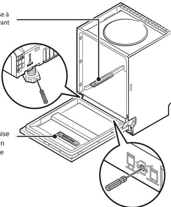
Vérifiez la mise à niveau d'un côté à l'autre
