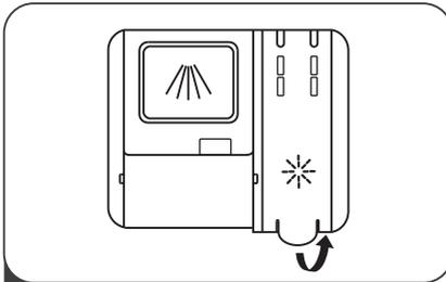
**1** Pour retirer le couvercle du réservoir de produit de rinçage, soulevez la poignée.
