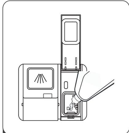
**2** Versez le produit de rinçage dans le distributeur en prenant soin de ne pas trop le remplir.
