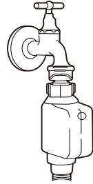
tuyau d'arrivée d'eau de sécurité
