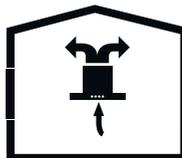
Fig. 6: Circulation de l'air du filtre à charbon
