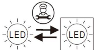
È costituita da diodi elettroluminescenti (LED). Questo tipo di diodo non può essere sostituito dall'utilizzatore. La durata di vita dei LED è solitamente tale da non necessitare la loro sostituzione. Se tuttavia, malgrado la cura con cui è stato costruito il frigo cantina, i LED dovessero essere difettosi, rivolgersi al proprio servizio assistenza per l'intervento.
