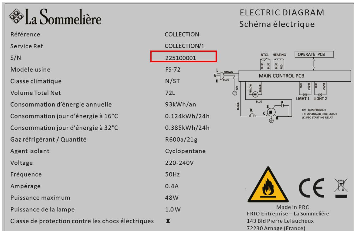
Das Typenschild befindet sich im Geräteinneren bzw. an der Geräterückseite (modellabhängig). Es enthält alle gerätespezifischen Angaben.
