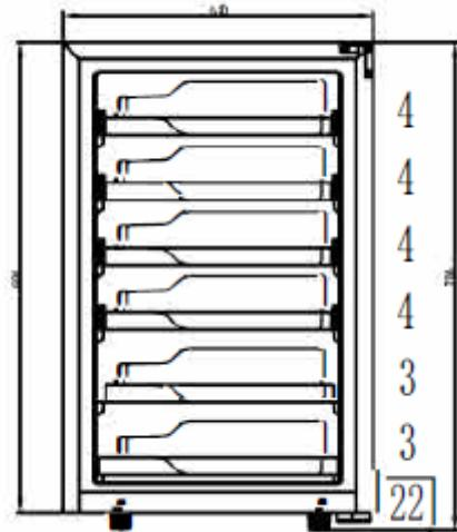
**Layoutempfehlungen:** Das folgende Layout der Geräte Ihres Geräts (Regale usw.) wird empfohlen, damit der Energieverbrauch des Geräts so rationell wie möglich ist.
