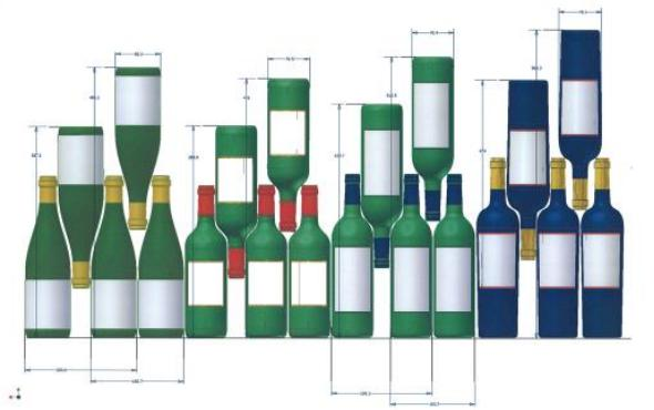
Aquí tenemos 4 tipos de botellas de 75 cl, borgoñonas y bordelesas, de dimensiones diferentes. Existen otros muchos otros tipos, de tamaño y forma diferentes. Puede observar las diferencias de colocación según la altura de las botellas, el diámetro y la manera de cruzarlas.
