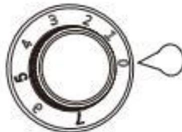
Votre appareil est équipé d'un thermostat situé à l'intérieur en haut de votre appareil. La première fois que vous mettez votre appareil en fonctionnement, mettez le thermostat sur 4 et laissez-le fonctionner à vide durant 4 heures avant d'y entreposer des aliments afin qu'il soit suffisamment refroidi.
