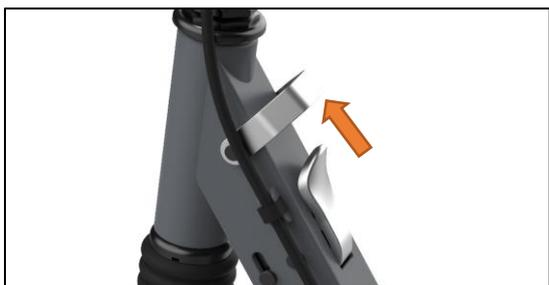
2. Appuyez sur la goupille de déverrouillage tout en relevant lentement le tube avant en position verticale.
