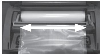
4. Placez une des extrémités du sachet qui n'est pas encore soudée sur la bande de scellement (14).
