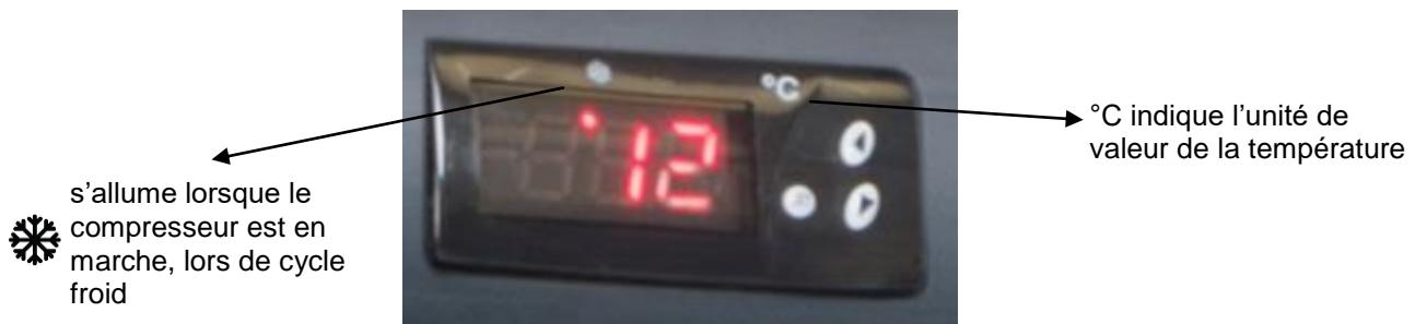
La température peut être ajustée au plus bas à 5°C et au plus haut à 18°C en fonction de vos besoins spécifiques. La température programmée souvent conforme est de 12°C.
