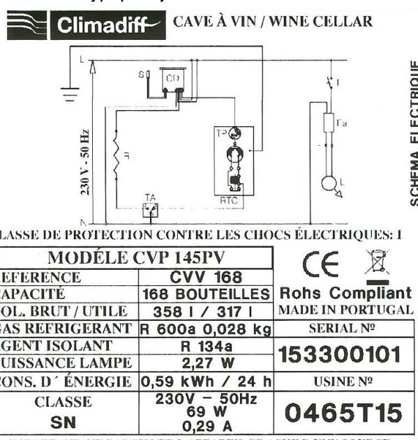
Het typeplaatje dat aan de binnenkant of achterkant van het apparaat (op basis van het model) gekleefd is, bevat alle specifieke informatie over uw wijnkast.
