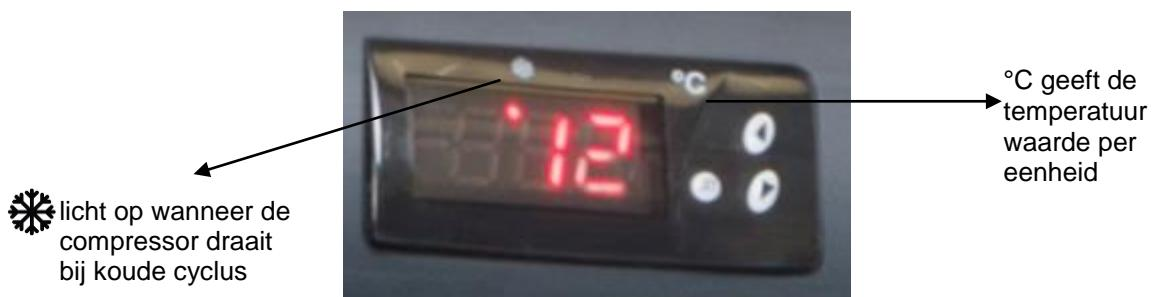
De temperatuur kan worden ingesteld van 5°C tot 18°C, zodat aan uw specifieke bewaareisen kan worden voldaan. De standaard ingestelde temperatuur is 12°C.
