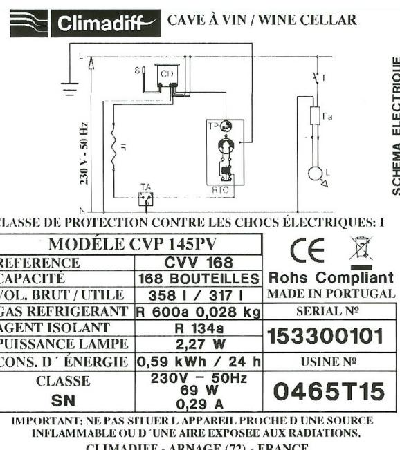
Das Typenschild befindet sich im Geräteinneren bzw. an der Geräterückseite (modellabhängig). Es enthält alle gerätespezifischen Angaben über Ihren Weinschrank.
