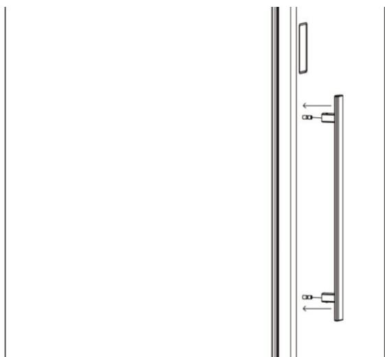
Étape 3 : une fois la poignée correctement installée sur les deux vis, utilisez un tournevis hexagonal pour fixer les deux vis hexagonales à l'aide d'un tournevis hexagonal comme indiqué sur la photo ci-dessous :
