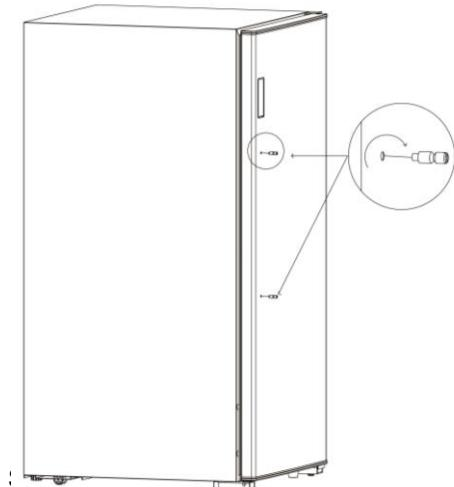
Griffbasis, fixieren Sie die Griffschraube in das Griffloch an der Unterseite des Grifffußes, wie auf der Zeichnung hier unten erklärt:
