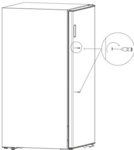
Stap 2: er zijn twee gaten op het handvat basis, bevestig de handgreep schroef in de handgreep gat in de bodem van de handgreep base zoals beschreven op de tekening hieronder:
