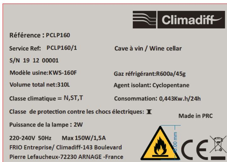
La placa de características pegada en el interior o en la parte posterior del aparato (según el modelo) contiene toda la información específica de la vinoteca.
