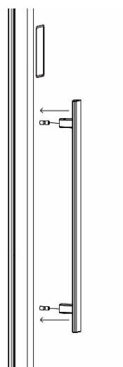
Fase 3: dopo aver montato correttamente la maniglia sulle due viti, usare un cacciavite esagonale per fissare le due viti esagonali come indicato nella figura qui sotto:
