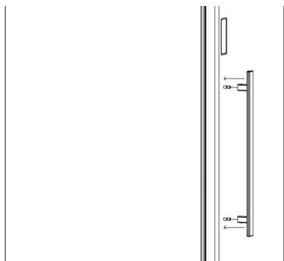
Stap 3: na greep op het handvat schroef is vastgesteld, zijn er twee zeskantschroeven knallen, gebruik dan een zeshoek schroevendraaier om de schroeven zoals hieronder foto's op te lossen:
