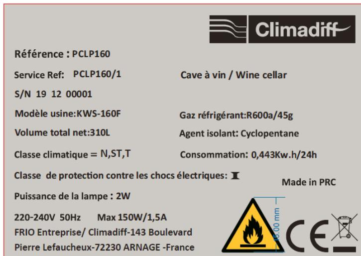
De op de binnen- of achterzijde van het apparaat (afhankelijk van het model) geplakte typeplaat bevat alle informatie betreffende uw apparaat.
