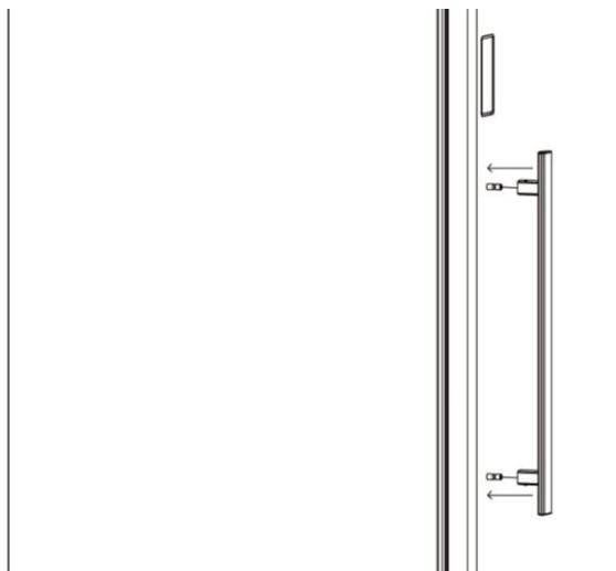
Schritt 3: Nachdem der Griff an der Griffschraube befestigt ist, befinden sich zwei Sechskantschrauben, die mit einem Sechskantschraubendreher zum Befestigen der Schrauben wie unten fotografieren:
