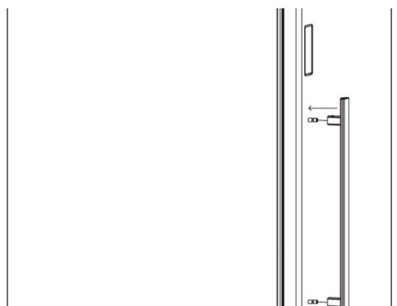
Paso 3: Una vez que el mango está instalado correctamente en los tornillos, utilice un destornillador hexagonal para asegurar los dos tornillos hexagonales con un destornillador hexagonal como se muestra en la imagen siguiente:
