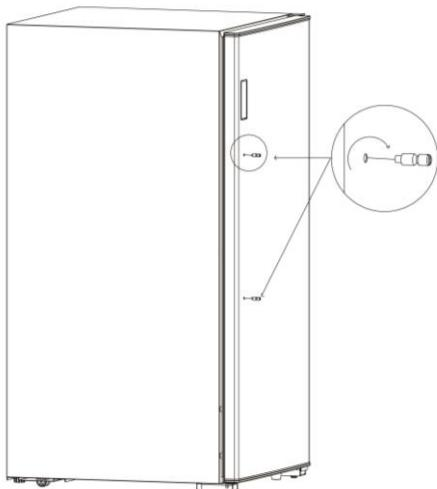
Paso 2: dos agujeros se hicieron en el mango, adjuntarlo en los tornillos previamente instalados como se muestra en la foto de abajo:
