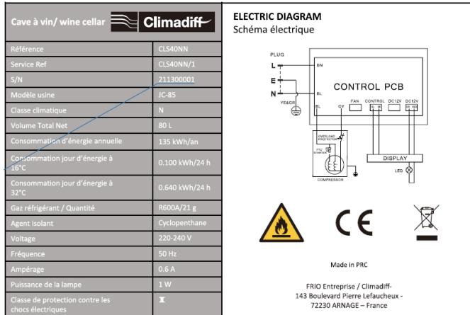
La targhetta informativa incollata all'interno o sul retro dell'apparecchio (a seconda del modello) contiene tutte le caratteristiche tecniche del frigo cantina.
