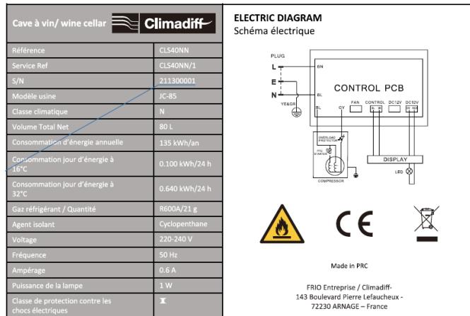
Das Typenschild befindet sich im Geräteinneren bzw. an der Geräterückseite (modellabhängig). Es enthält alle gerätespezifischen Angaben.
