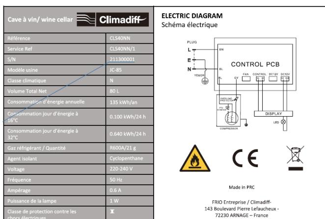
La placa de características pegada en el interior o en la parte posterior del aparato (según el modelo) contiene toda la información específica de la vinoteca.
