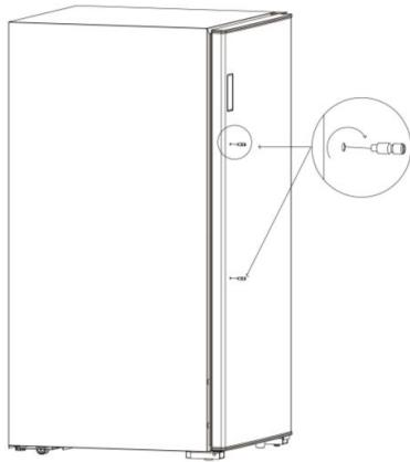
Schritt 2: Es gibt zwei Löcher an der Griffbasis, fixieren Sie die Griffschraube in das Griffloch an der Unterseite des Grifffußes, wie auf der Zeichnung hier unten erklärt:
