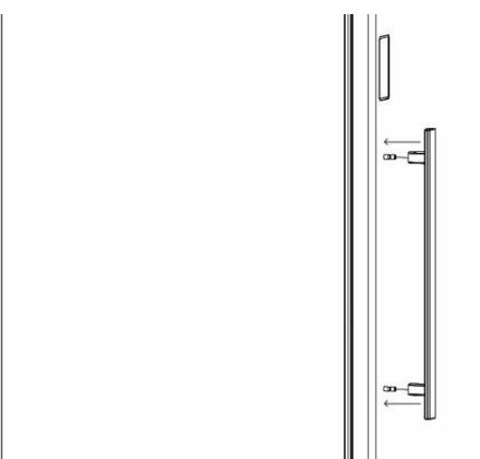
Fase 3: dopo aver montato correttamente la maniglia sulle due viti, usare un cacciavite esagonale per fissare le due viti esagonali come indicato nella figura qui sotto:
