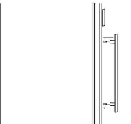
Stap 3: na greep op het handvat schroef is vastgesteld, zijn er twee zeskantschroeven knallen, gebruik dan een zeshoek schroevendraaier om de schroeven zoals hieronder foto's op te lossen:
