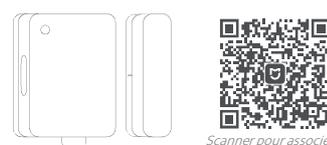
Appliquer les étiquettes adhésives à l'intérieur des rainures du détecteur et de l'aimant. Enlever le film de protection et placer le dispositif en alignant autant que possible les repères d'installation. S'assurer que l'espace est inférieur à 18mm. Scanner le QR code ci-dessus afin d'accéder à l'application Xiaomi Home. Suivre les instructions de l'application.
