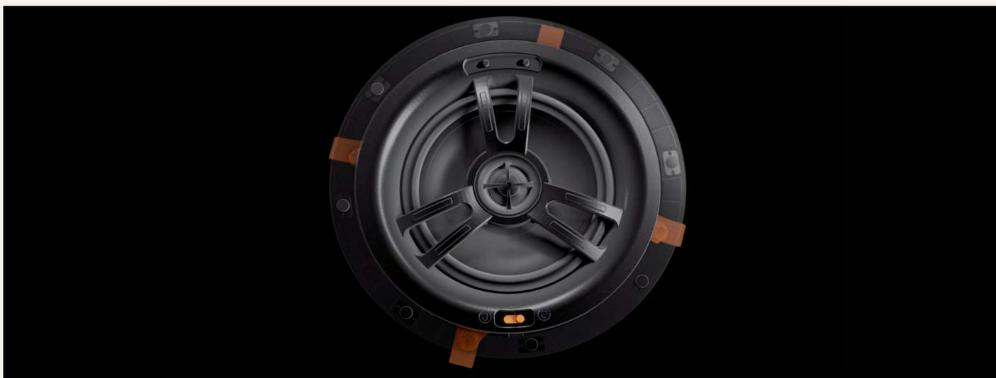
L'EMT7 est un modèle type 2 voies coaxial. L'enceinte est équipée d'un haut-parleur médium-grave de 17 cm à membrane en polypropylène, et d'un Tweeter orientable à dôme soie de 25mm.
