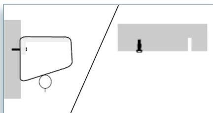
3 - Placer les chevilles dans les trous et visser l'écran sur le mur ou placer juste la vis dans le plafond
