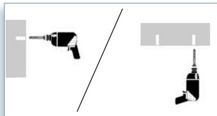
2 - Percer le ou les trous diamètres 5mm
