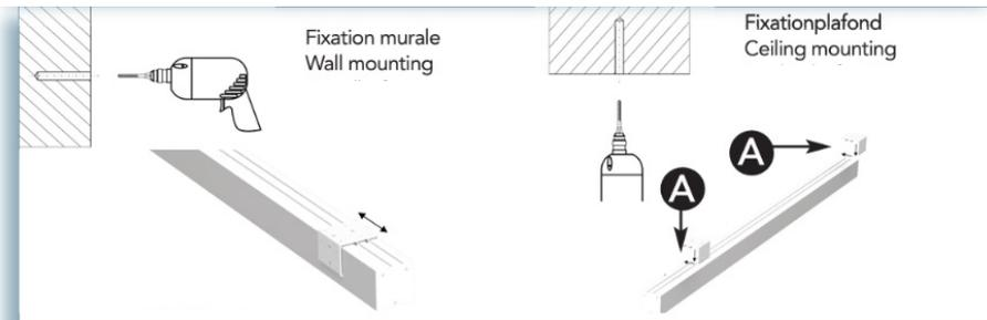
Positionner l'écran et les fixations et verrouiller l'installation à l'aide des vis de blocage.
