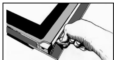
Faites levier sur l'ensemble afin de déclipper le cadre et sa vitre.
