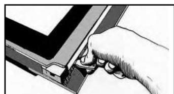
Поднимите как рычагом каркас, чтобы отщелкнуть каркас со стеклом.
