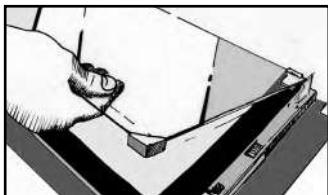
Die Einheit besteht aus 2 Scheiben, von denen die 1. Scheibe 2 Distanzstücke aus Gummi in den beiden vorderen Ecken hat.
