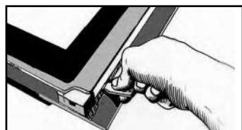
Użyć efektu dźwigni, aby rozłączyć ramę i szybę.
