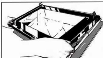
Fare attenzione a inserire correttamente la cornice sotto il perno a lato della cerniera.
