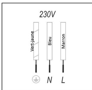
La connexion électrique s'effectue par un interrupteur omnipolaire
