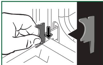
Retirez la première vitre clipée : appuyez à l'aide d'un outil (tournevis) dans les emplacements (A) afin de décliper la vitre puis retirez-la.
