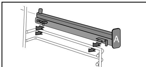
**POZNÁMKA:** teleskopická posuvná část kolejnice se musí rovinout směrem k přední části trouby, stop A směrem k vám.
