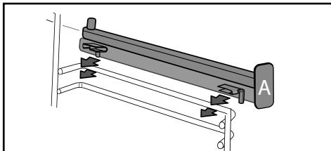
NOTA : la parte telescópica deslizante de la guía se despliega hacia la parte delantera del horno, con el tope **A** orientado hacia usted.
