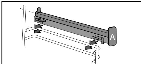
**HINWEIS:** Der teleskopartige Teil der Schiene muss zur Ofenvorderseite hin ausziehbar sein, der Anschlag **A** befindet sich gegenüber von Ihnen.
