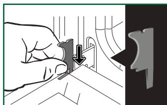
Pressione com a ajuda de uma ferramenta (aparafusadora) nos encaixes **A** para retirar o vidro.
