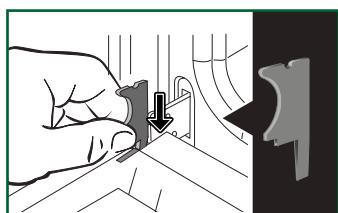
Retirez la première vitre clipée : appuyez à l'aide d'un outil (tournevis) dans les emplacements (A) afin de déclipper la vitre puis retirez-la.
