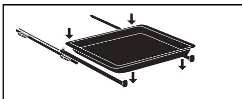
Zur Demontage der Schienen entfernen Sie die Einschubleisten.
