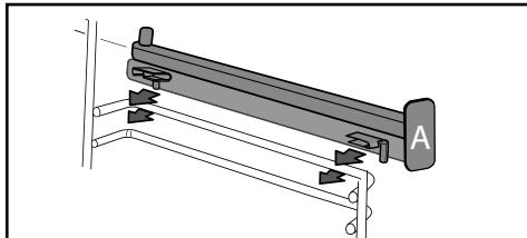
N.B.: het uitschuifbare schuifgedeelte van de rail moet naar de voorkant van de oven uitgeklapt worden, het blokje **A** bevindt zich tegenover u.
