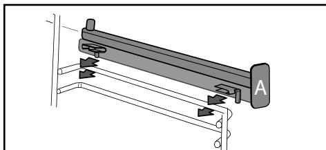
OBS!: glidskenans teleskopiska del ska utvecklas mot ugnens front, med anslaget vänt mot dig.
