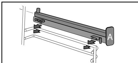
**BEMÆRKNING:** Den teleskopiske del af skinnen skal udfoldes ud ad ovnen, og endestoppet **A** skal være foran dig.
