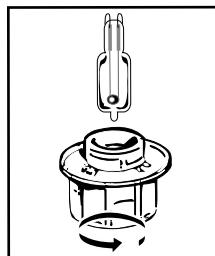
Vous pouvez remplacer vous-même la lampe lorsqu'elle ne fonctionne plus. Dévissez le hublot puis sortez la lampe (utilisez un gant de caoutchouc qui facilitera le démontage). Insérez la nouvelle lampe et replacez le hublot. Ce produit contient une source lumineuse de classe d'efficacité énergétique G.
