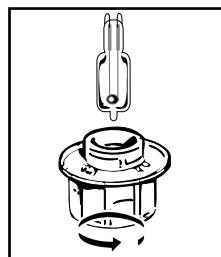
Ak žiarovky nefungujú, môžete ich vymeniť sami. Zložte tienidlo a potom odskrutkujte žiarovku (použite gumenú rukavicu, ktorá uľahčí vymontovanie). Namontujte novú žiarovku a nasadte späť tienidlo.
