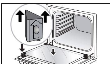
Włożyć ostatnią szybę do metalowych ograniczników, a następnie zamocować na klips, stroną z napisem „PIROLIZA” ustawioną w kierunku użytkownika i czytelną.
