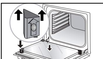
Vložte zadné sklo do kovových držiakov, potom ho zavaknite tak, aby bol na čele nápis „PYROLYTIC“ otočený smerom k vám a aby bol čitateľný.
