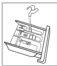
2. Nettoyez le tiroir à détergent sous l'eau
