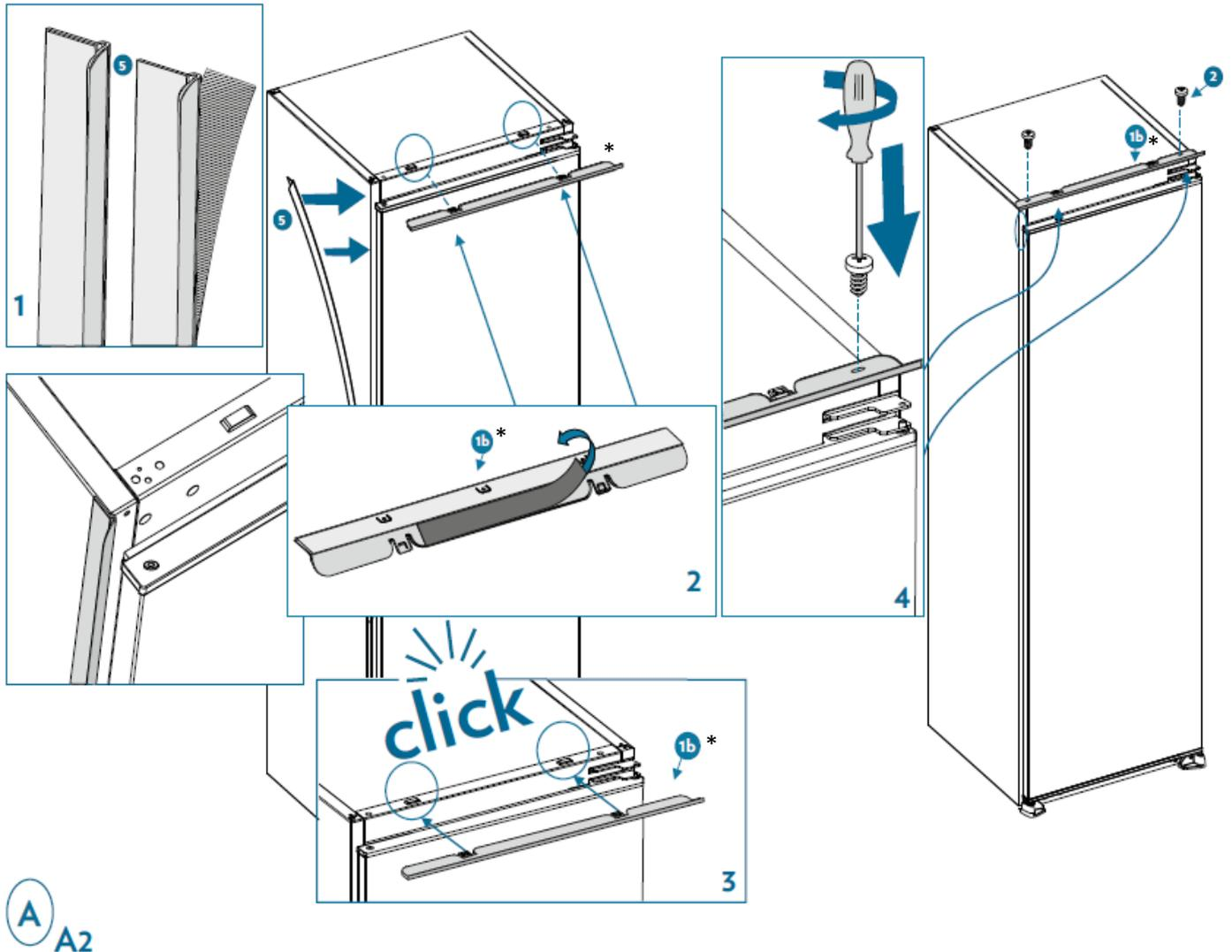
3. Glissez avec précaution l'appareil dans le caisson d'encastrement. Assurez-vous que le côté d'ouverture de la porte soit le plus proche possible de la paroi du caisson.
