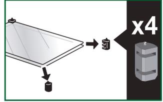
Retirez la première vitre : la porte est composée de deux vitres intérieures avec à chaque coin une entretoise noire en caoutchouc. Si nécessaire, extraire les vitres intérieures pour les nettoyer. Ne pas immerger les vitres dans l'eau. Rincez à l'eau claire et essuyez avec un chiffon non pelucheux.
