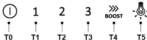
**T0= Touche OFF moteur (stand by) – Désactivation de l'Électronique – Reset signalisation lavage / remplacement filtres.**
