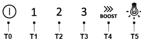
**T0= Tecla OFF motor (stand by) – Exclusão da Electrónica - Reset sinaliza lavagem/substituição filtros.**
