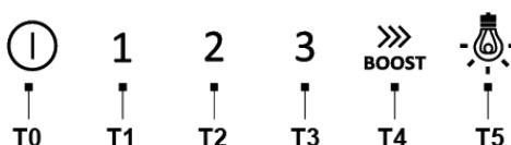
**T0= Κουμπί OFF (stand by) - Διακοπή παροχέα ηλεκτρισμού - Reset ένδειξη πλυσίματος/αντικατάστασης φίλτρων.**
