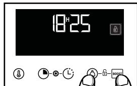
Appuyez simultanément sur les touches ⓧ et ☰ jusqu'à l'affichage du symbole 🔒 à l'écran. Pour le déverrouiller, appuyez simultanément sur les touches ⓧ et ☰ jusqu'à ce que le symbole 🔒 disparaît de l'écran.
