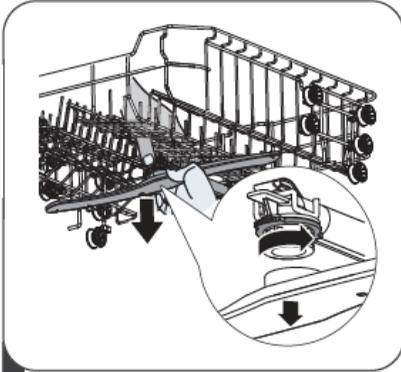
**1** Pour retirer le bras d'aspersion supérieur, immobilisez l'écrou au centre et faites tourner le bras d'aspersion dans le sens inverse des aiguilles d'une montre.
