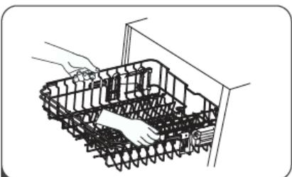
**1** Pour relever le panier du haut, soulevez simplement le panier du haut en le tenant de part et d'autre au milieu, jusqu'à ce que le panier s'accroche en position haute. Il n'est pas nécessaire de soulever la poignée de réglage.
