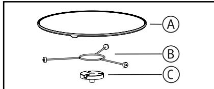
Om du tar ut stödet med drivnavet, se till att det inte kommer in vatten i motoraxelns öppning.
