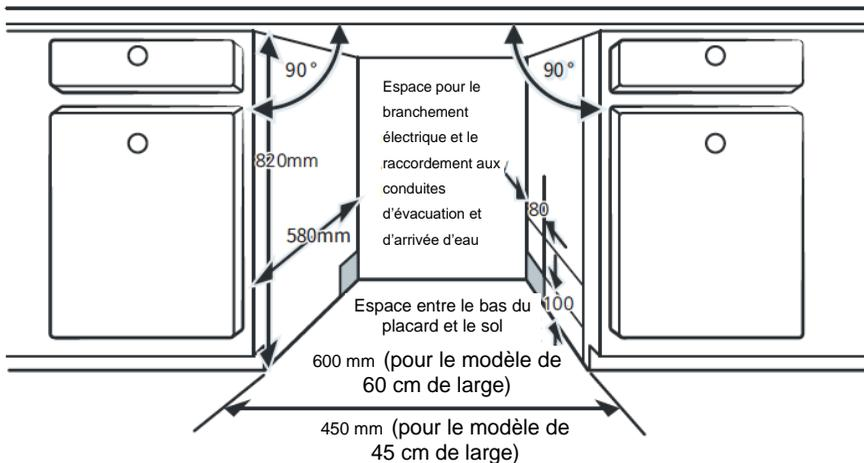
2. Si le lave-vaisselle est installé près d'un angle, prévoyez une distance de sécurité pour l'ouverture de la porte.
