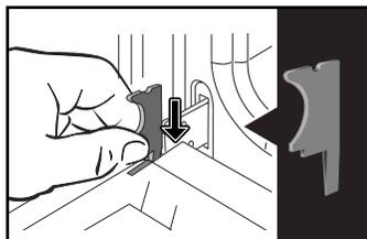
Retirez la vitre clipée : appuyez à l'aide d'un outil (tournevis) dans les emplacements (A) afin de déclipper la vitre puis retirez-la.
