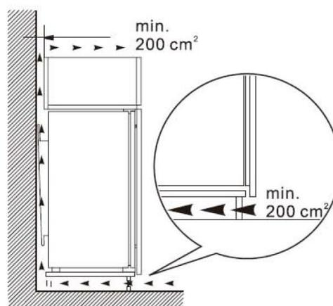
2. Glissez avec précaution l'appareil dans le caisson d'encastrement. Assurez-vous que le côté d'ouverture de la porte soit le plus proche possible de la paroi du caisson.
