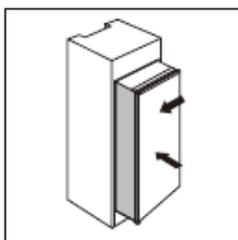
3. Vissez un guide dans les trous du côté de l'appareil avec les vis courtes. Insérez la glissière dans le guide puis ouvrez en grand et refermez la porte de l'appareil et la porte du caisson afin de vérifier que cette dernière se ferme complètement et facilement.
