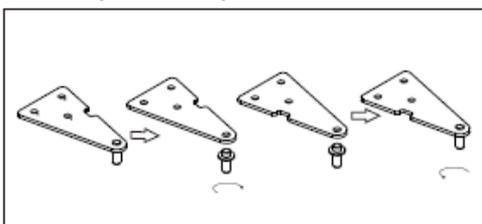
4. Remplacez la porte puis déplacez la charnière supérieure du côté gauche. Assurez-vous que la porte est alignée horizontalement et verticalement de manière à ce que les joints soient fermés de tous les côtés avant de resserrer la charnière supérieure. Si nécessaire, utilisez une clé plate pour resserrer la charnière.
