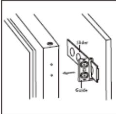
8. Vérifiez que la porte s'ouvre et se ferme facilement et que l'assemblage est correctement fixé. Réajustez la position de l'appareil si nécessaire. Fixez ensuite le support de charnière inférieur au caisson avec les 2 vis longues.
