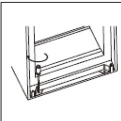
9. Fixez le support de charnière supérieur au caisson avec des vis courtes.
