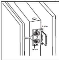
4. Ouvrez la porte de l'appareil et la porte en bois ensemble et marquez la position de la glissière par des repères à l'endroit où la porte peut s'ouvrir et se fermer correctement. Retirez la glissière du guide et fixez-la sur la porte du caisson avec 2 vis courtes. Fixez ensuite le cache de la glissière sur la glissière.
