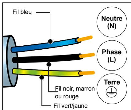
**⚠ Attention : Si l'installation électrique de votre habitation nécessite une modification pour le branchement de votre appareil, faites appel à un électricien qualifié. Si le four présente une quelconque anomalie, débranchez l'appareil ou enlevez le fusible correspondant à la ligne de branchement du four.**
