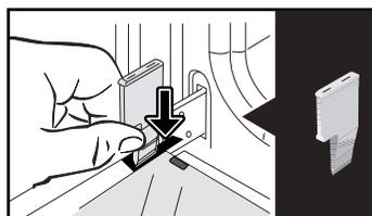
Retirez la première vitre clippée : A l'aide de l'autre cale (ou d'un tournevis) appuyez dans les emplacements **A** afin de déclipper la vitre.
