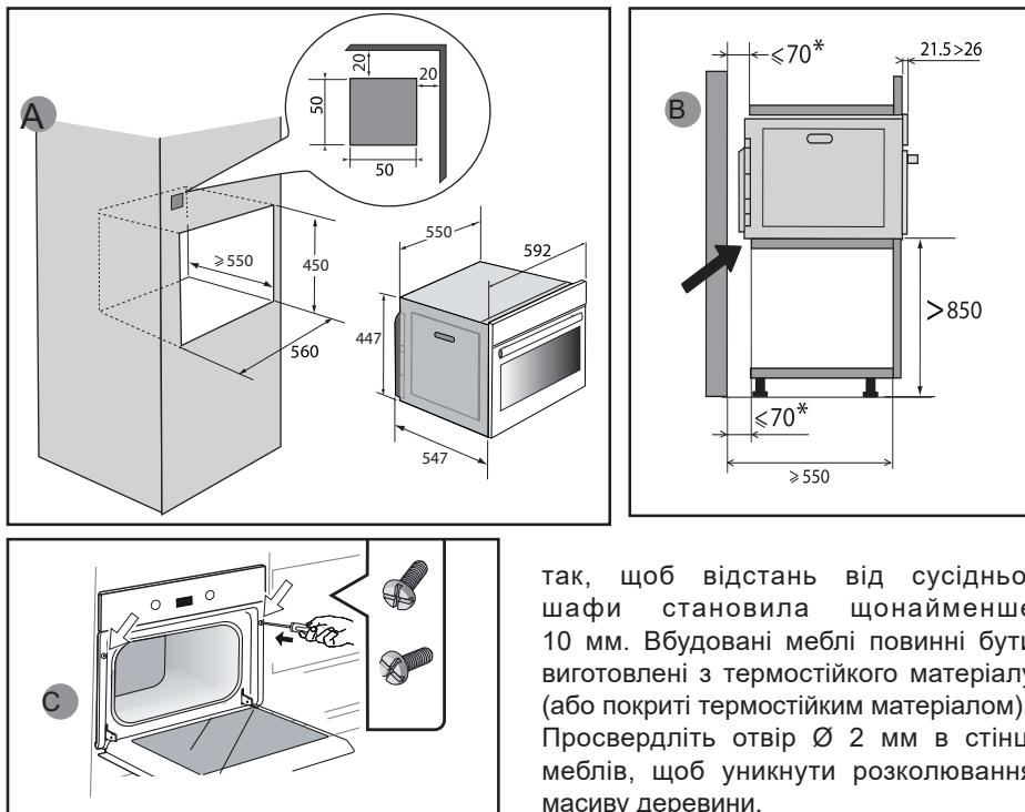
Цей пристрій необхідно встановлювати на висоті більше 850 мм від підлоги. Його можна встановлювати в шафі-пеналі, як показано на схемі монтажу (рис. А).
