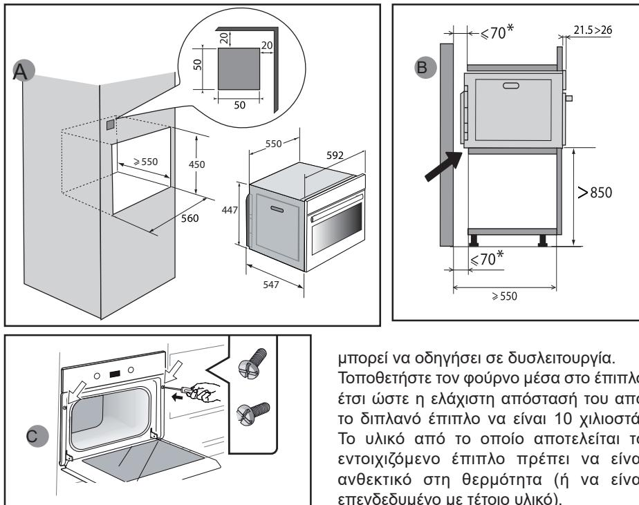
Αυτή η συσκευή πρέπει να εγκαθίσταται σε απόσταση μεγαλύτερη από 850 χιλιοστά από το έδαφος. Μπορεί να εγκατασταθεί σε στήλη όπως υποδεικνύεται στο σχέδιο εγκατάστασης (εικ. Α).
